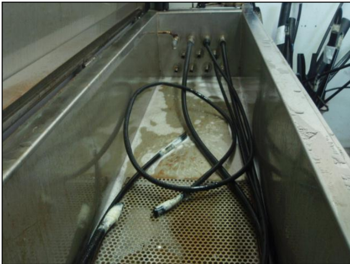
Imagen 5. Realización del ensayo de sauna a las tuberías.
