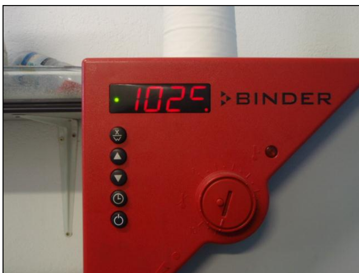
Imagen 1. Estufa en la que se realiza el ensayo de stress-cracking a 100°C, superior a los 70°C que indica la norma correspondiente.
