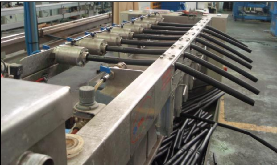
Máquina de realización de ensayo de flujos y caudales a la tubería.
