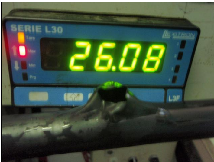
Imagen 6. Ensayo de reventamiento de presión. Rotura en forma de poma, dúctil y rompiendo a 26 bar de presión.
