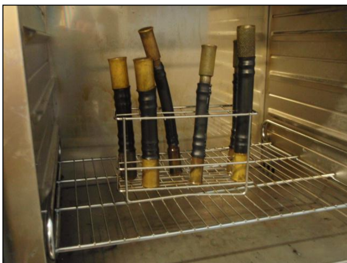
Imagen 2. Muestras sobre las que se realiza el ensayo de stress-cracking después de la realización del ensayo. Ninguna muestra se raja después del ensayo. Ensayo superado con plenas garantías.
