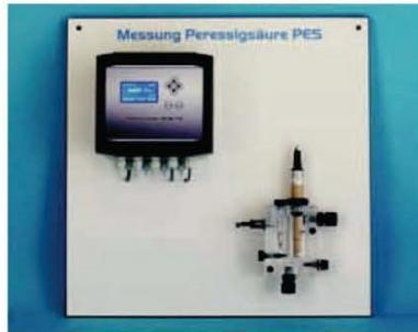
.Sistemas de medición completa, montaje en panel-, control - y medición con sensor específico dependiendo de la aplicación. Están diseñados individualmente también a especificación del cliente
