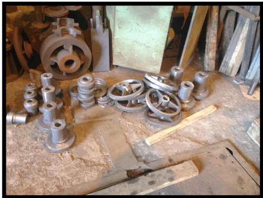
Figura 5. Piezas elaboradas en fundición de hierro.
