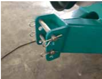
Abnehmbare und verstellbare Zugöse Inel de remorcare detașabil și reglabil Anillo de tracción removible y ajustable
