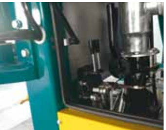
Steuerhebel des Saugschlauchhalterarms Lever de comandă pentru brațul de aspirare Palanca de control para el brazo de succión
