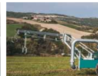
Armhalter zum Anheben des Saugrohres Braț pentru ridicarea conductei de aspirație Brazo para levantar el tubo de aspiración
