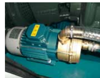
Elektrische Ansaugpumpe Electropompă cu amorsare cu vid Bomba de cebado eléctrica
