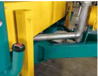
Doppelter Stützfuß und doppelte Nachfüllung Picioar stabilizator dublu, punct de umplere dublu Doble piera, doble punto de llenado
